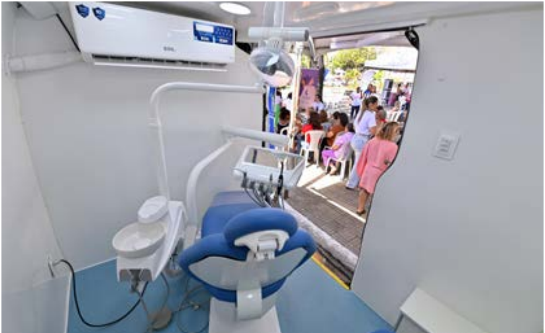
Consultório móvel conta com cadeira odontológica, refletor, aparelho de raio-X, autoclave
