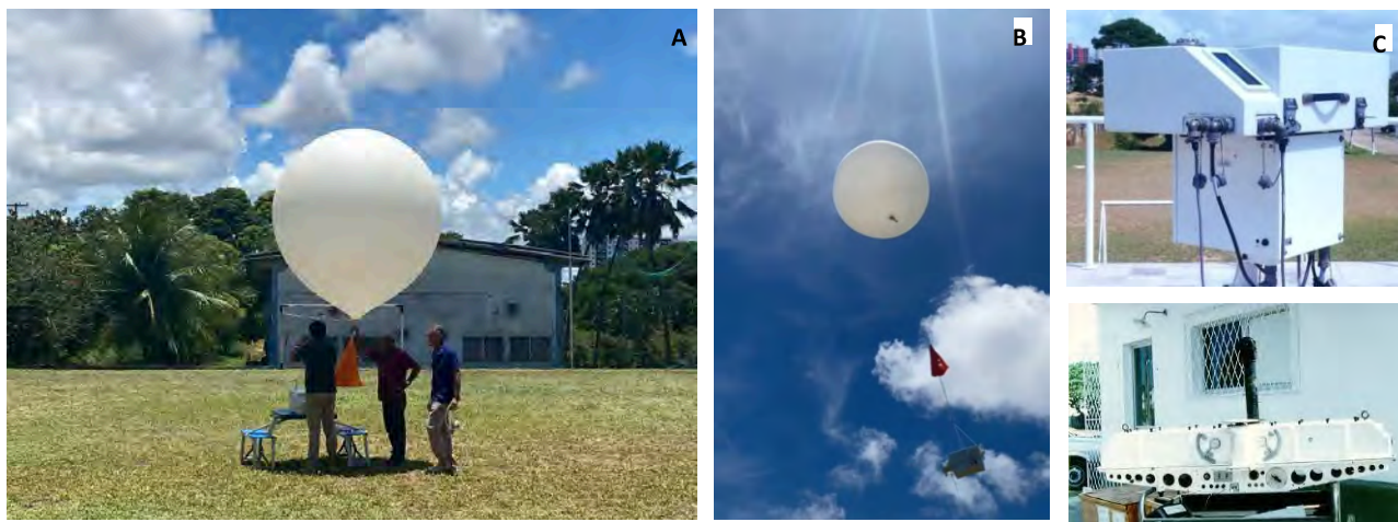
Figura 33: Lançamento de balão com instrumentos de coleta de dados (A e B) Espectrofotômetros de Brewer (C) e Dobson (D)
