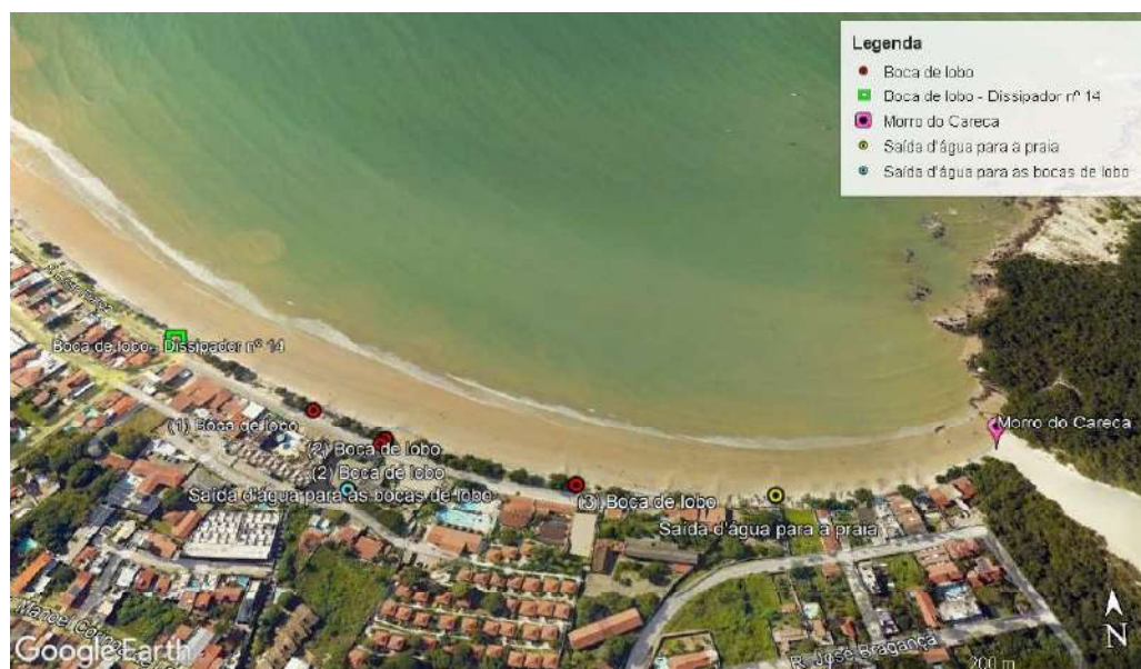
Figura 11: Distribuição dos dispositivos de drenagem observados entre o dissipador nº 14 e o Morro do Careca. Fonte: Imagem do Google Earth .
