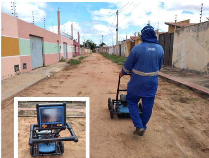
‘Georadar’ detecta tubulações em até 8m de profundidade
